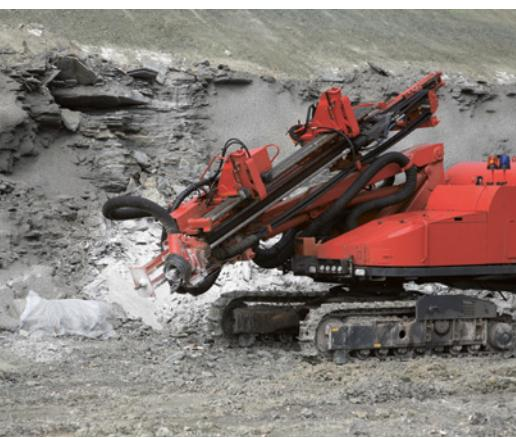
**Zusätzliche Nutzlast & Standsicherheit** Bohrgeräte können durch die Gewichtseinsparung unserer Light Line Hydraulic® zusätzliche Lafetten mitführen, was die Produktivität entscheidend erhöht. Weiters ermöglicht der Leichtbau z.B.: bei **Bohrgeräten** ein Reduzieren des zusätzlich angebrachten Gegengewichts, bei gleichbleibender Standsicherheit.
